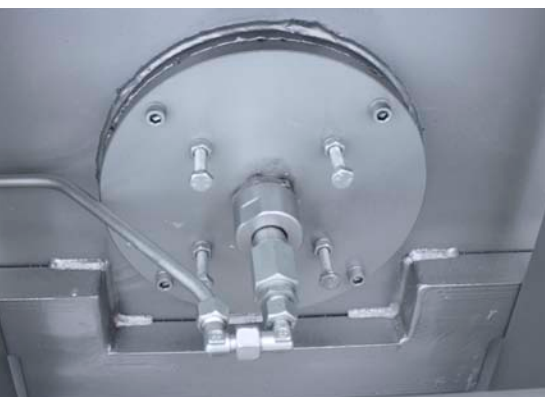
Sistema de desgasificación / Degassing System
