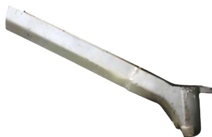
Canaleta de Fundido y Acero inoxidable / Cast and refractory Steel Launder
